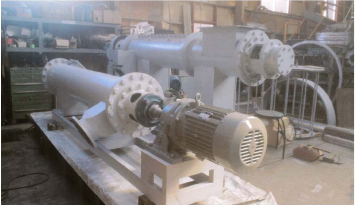
写真4 2連の高剪断力木材粉碎機 (処理能力 0.3~0.5 t/時)
