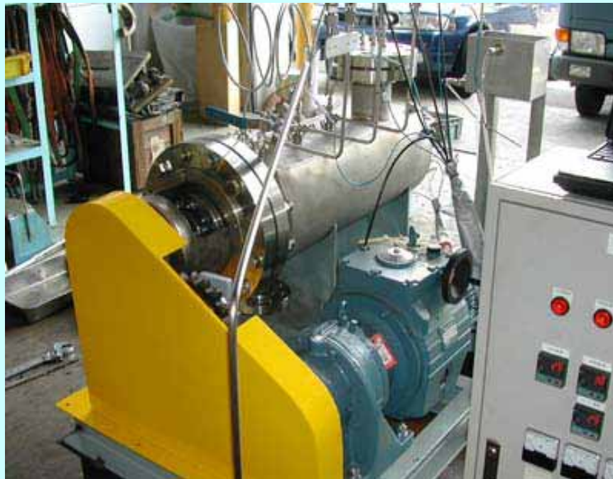
写真 高剪断力(Max 1 Mpa)・高温・高圧ニーダー
