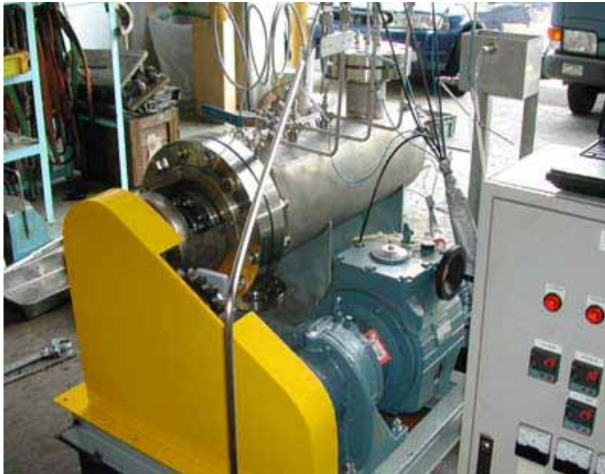
写真 1 (a) 高剪断力・高温・高圧ニーダ
