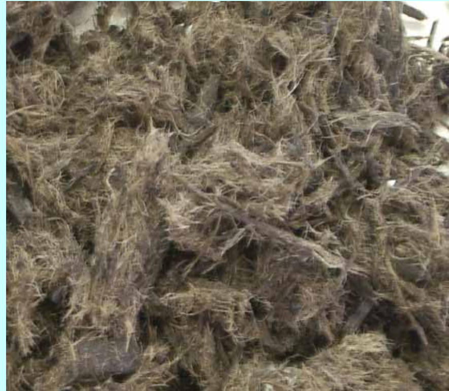
投入完了時(取出口より採取) 充填材として利用
