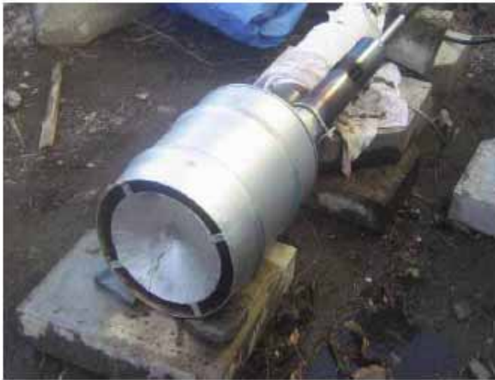
(a) 蒸気みの噴霧 (パイロットバーナー燃焼中)
