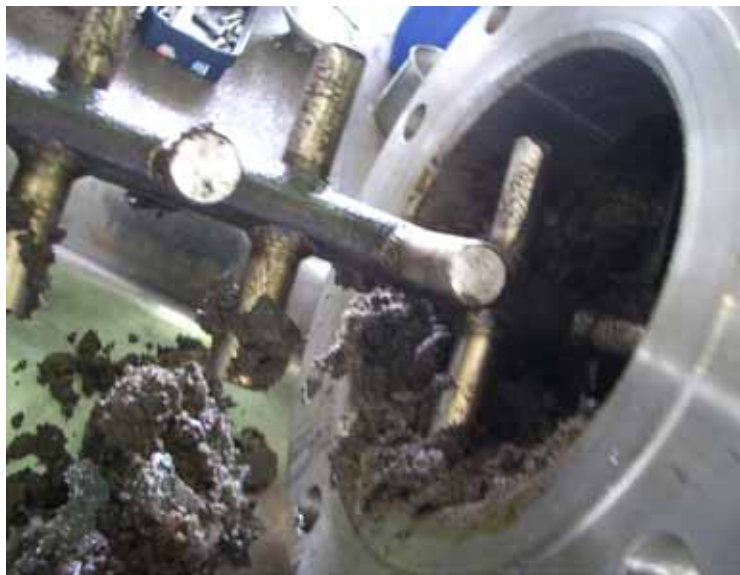
写真3 RUN - 6のシュレッダー屑と汚泥土砂の混合物
