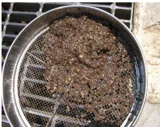
写真6 RUN - 7の羽根の隙間からの回収物の全量
