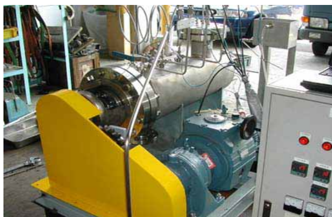
写真1(a) 高切断力、高温、高圧ニーダー
