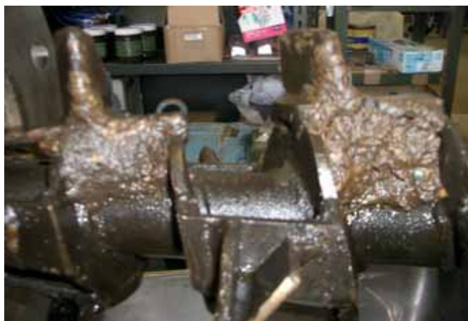
写真5 RUN - 7の高剪断力の羽根に残ったシュレッダー屑
