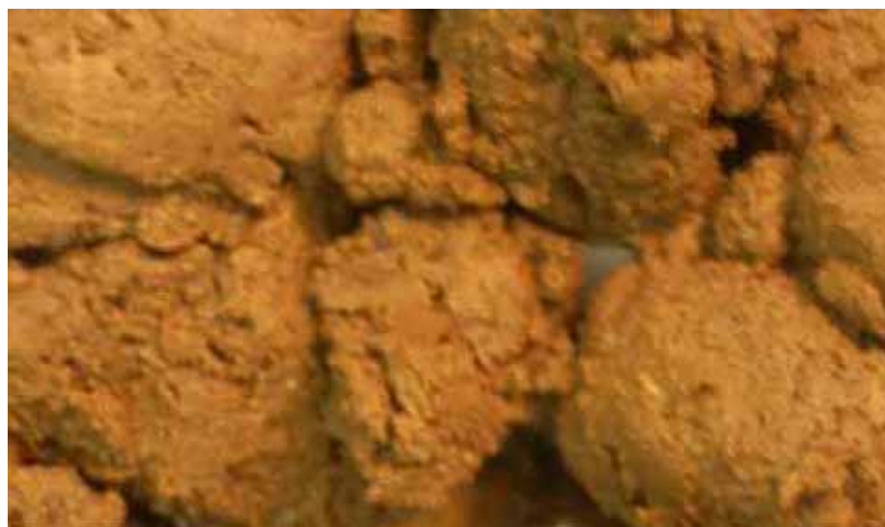
写真1 C町の脱水汚泥(スラリー化原料)
