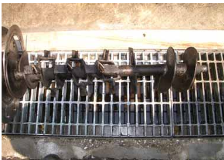
写真1 剪断力を掛けられる羽根
