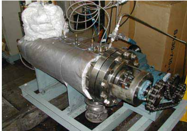
写真 1 (b) 高剪断力、高温、高圧ニーダー
