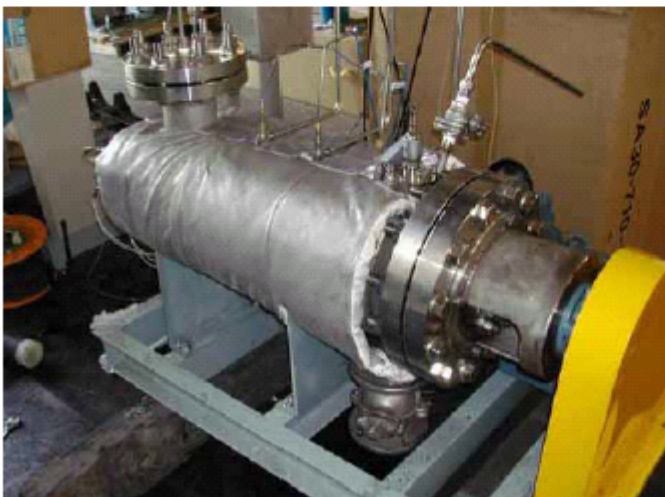
写真2 サンプル試験用ニーダ（剪断力 0.4 ~ 1.0 MPa 処理温度 = 最高 300 、 処理圧力 = 最高 3 MPa、20 の容量）
