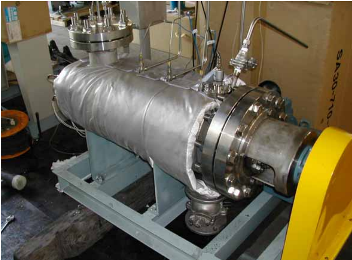
写真3 高剪断力・加熱・加圧型ニーダ
